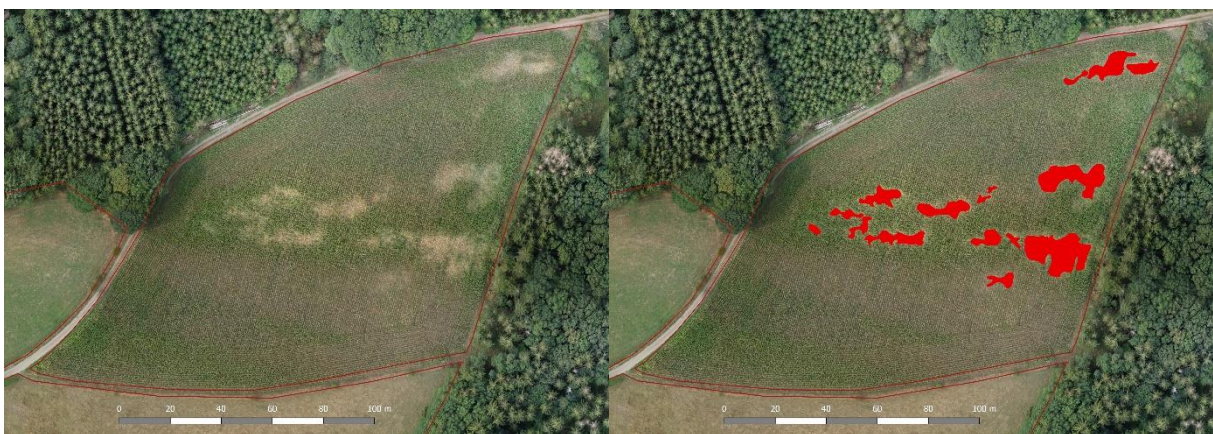
Abbildung 3: Entzerrungsfreies und hochaufgelöstes Orthofoto (links) und Schadenskartierung (rechts)
