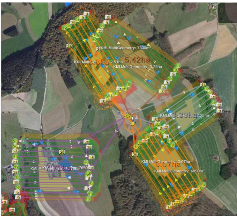
Abbildung 2: Die Flugplanung wird am Boden erstellt und an das unbemannte Flugzeug gesendet.
