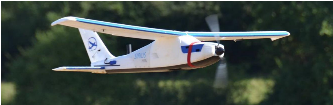
Abbildung 1: Unbemanntes Flugsystem zur Bilddatenerhebung
